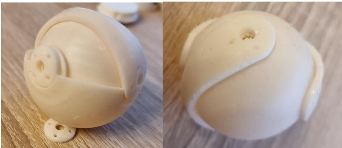
Figura 3.3. Articulație generată tip Hooke, protipare tip SLA rășină
