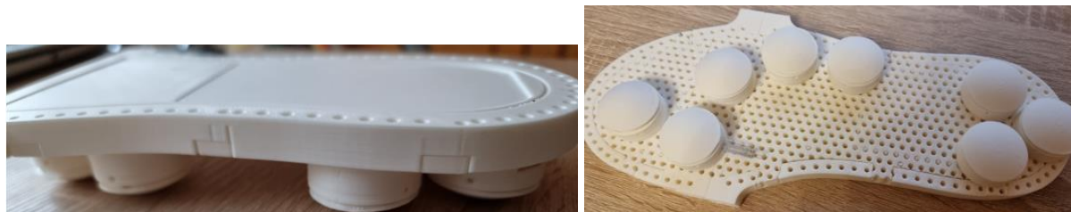
Figura 2.9 Talpă sanda cu rețeaua senzorială montată
